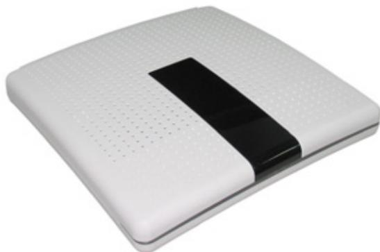
Figura 2 - Equipamento terminal ONT da PT Inovação
