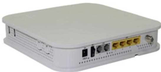
Figura 6 - Equipamento terminal ONT-RGW-S
